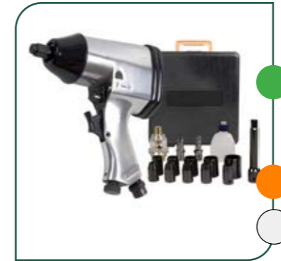
Slagmoersleutel Deluxe Drijfjas is 1/2 vierkant. Werkdruk: 6.3 bar. Onbelast toerental van 7000/min. Max. boutcapaciteit: 16mm. Max. draaimoment: 310 Nm.
