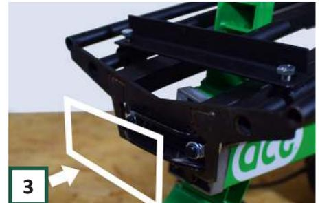
**3** Schieben Sie dann die Aussparung an der Vorderseite des Schiebetisches über den Kolbenstangenkopf der Maschine.
