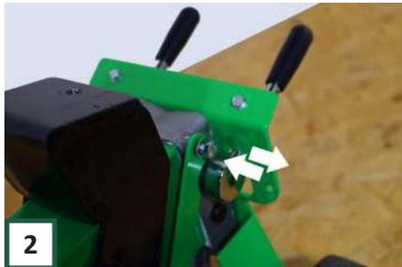
**2** Nach entfernen der Halterungen die zwei Schrauben auf der Bedienseite wieder anziehen.
