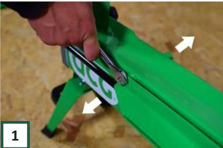
**1** Demontieren Sie die Holzhalterungen an beiden Seiten der Maschine, indem Sie die vorderen und hinteren Schrauben lösen.
