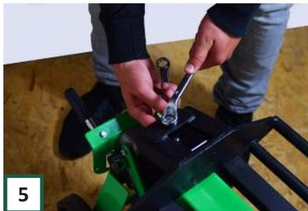
**5** Drücken Sie die Schiebetisch mit den Schrauben, Muttern und der Klemmplatte auf die Pushblock. (Scheibe unten / im Pushblock.)
