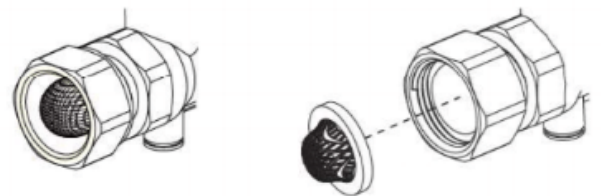
Water filter bevestigd
