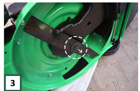
**3** Lösen Sie mit Schlüssel 14 die Schraube in der Mitte das Messer, indem Sie sie gegen den Uhrzeigersinn drehen. Halten Sie das Messer mit der anderen Hand (verwenden Sie gegebenenfalls ein altes Tuch oder Handschuhe zum Greifen).
