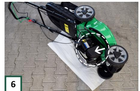
**6** Befestigen Sie den Lenker mit 4 Schlittenschrauben und Muttern an der Außenseite der Halter an der Maschine. Verwenden Sie den Schraubenschlüssel 13. Schrauben innen, Muttern außen.
