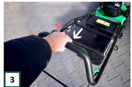
**3** Stellen Sie sich hinter die Maschine und drücken Sie mit der linken Hand auf den vorderen Steuerhebel. (Der Betrieb des Motors)
