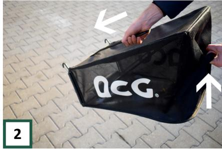
Der Fangkorb hat also eine Halterung und einen praktischen Griff auf der Rückseite. Sie können den Beutel leicht kippen, um das gesammelte Gras zu entfernen. Dann ersetzen Sie der Korb.
