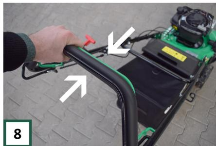
**8** Es ist auch möglich, die Selbstfahrfunktion durch betätigen des hinteren Hebels zu aktivieren.
