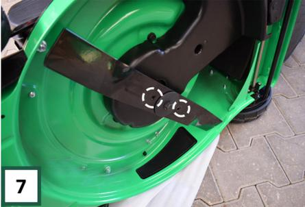
Ziehen Sie die Klinge richtig an und prüfen Sie, ob die T-Kupplung richtig in die Klinge eingreift, damit sie gesichert ist. Die Klinge wurde jetzt ersetzt, Sie können die Maschine wieder aufrecht stellen
