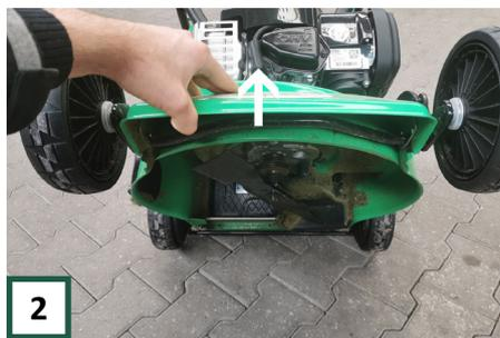
**2** Dann die Maschine mit den Vorderrädern in der Luft und dem Griff/ Lenker auf dem Boden nach hinten kippen.
