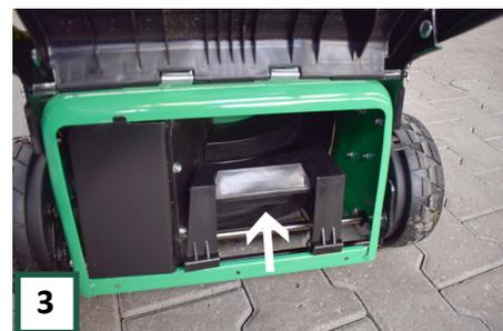
Setzen Sie nun den Mulchstopfen in das Loch für die hintere Entladung. Legen Sie den Beutel nicht zurück, Die hintere Klappe hält den Mulchstopfen an Ort.
