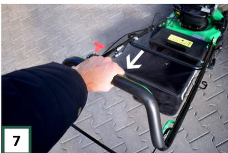
**7** Sie können die Maschine benutzen, indem Sie den vorderen Hebel gedrückt halten und die Maschine drücken. Um den Motor zu stoppen, lassen Sie den grünen Hebel los.
