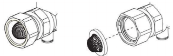
Wasserfilter angebracht Wasserfilter entfernt
