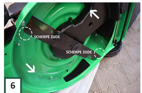
**6** Stecken Sie die Schraube mit den Tellerfeder durch die neue Klinge. ACHTUNG! Von unten gesehen dreht das Messer gegen den Uhrzeigersinn. Überprüfen Sie, ob sich die scharfe Seite an der richtigen Stelle befindet.
