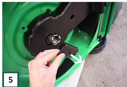
**5** Wenn sich die Kupplung von der Welle löst, stellen Sie sicher, dass der „Halbmond Feder“ nicht aus der Welle fällt! Ersetzen Sie die Baugruppe wie in Schritt 4 beschrieben.
