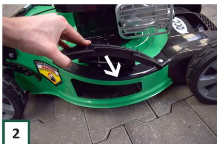
Stellen Sie sicher, dass der Seitenauswurf entfernt ist.
