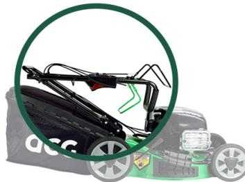
Bewahren Sie den Rasenmäher einfach mit dem praktischen Klapplenker auf. Öffnen Sie die Klemmen auf beiden Seiten der Lenker und klappen Sie die Lenker nach vorne über die Maschine. Sie können jetzt den Rasenmäher aufbewahren. Optional können Sie den Fangkorb platzsparend auf die Maschine stellen.
