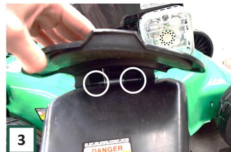
Platzieren Sie dann den Aufsatz für den Seitenauswurf indem Sie ihn unter das Scharnier der Schutzabdeckung einhängen. Der Seitenauswurf ist jetzt vorhanden.
