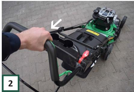
Stellen Sie sich hinter die Maschine und drücken Sie mit der linken Hand auf den vorderen Steuerhebel. (Der Betrieb des Motors)
