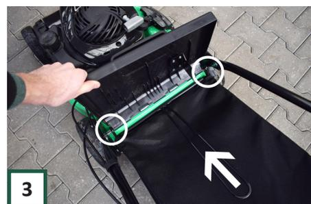
Platzieren Sie dann den Fänger oder die hintere Entladung, indem Sie die hintere Klappe hochziehen und das Teil am Rahmen einhaken.
