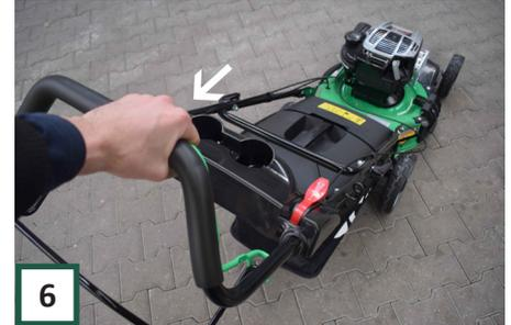
Sie können die Maschine benutzen, indem Sie den vorderen Hebel gedrückt halten und die Maschine drücken. Um den Motor zu stoppen, lassen Sie den grünen Hebel los.
