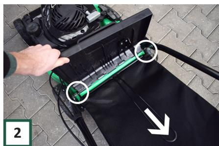
Entfernen Sie dann den Fangkorb oder die hintere Entladung, indem Sie die hintere Klappe hochziehen und das Teil entfernen.
