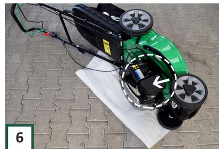
**6** Befestigen Sie den Lenker mit 4 Schlossschrauben und Muttern an der Außenseite der Halter an der Maschine. Verwenden Sie den Schraubenschlüssel 13. Schrauben innen, Muttern außen.
