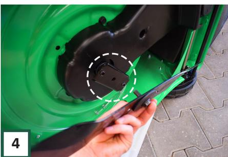
**4** Lösen Sie die Schraube vollständig und entfernen Sie das Messer. Sie sehen nun eine T-Kupplung, wie oben im Kreis gezeigt. Stellen Sie sicher, dass es an Ort und Stelle bleibt.
