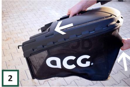
Der Fangkorb hat also eine Halterung und einen praktischen Griff auf der Rückseite. Sie können den Beutel leicht kippen, um das gesammelte Gras zu entfernen. Dann ersetzen Sie den Korb.
