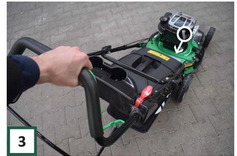
Ziehen Sie nun das Starterseil des Motors mit der rechten Hand in einer sanften Bewegung nach hinten. Der Motor sollte nun innerhalb weniger Hübe starten.
