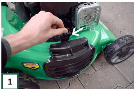
Wenn Sie die Seitenauswurf verwenden möchten, setzen Sie den Mulchstopfen ein und entfernen Sie den Korb. Ziehen Sie dann den seitlichen Auslassclip nach oben.
