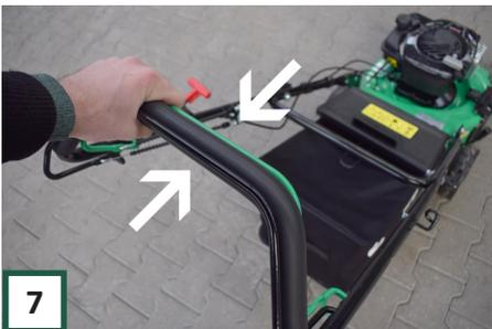
Es ist auch möglich, die Selbstfahrfunktion durch betätigen des hinteren Hebels zu aktivieren.
