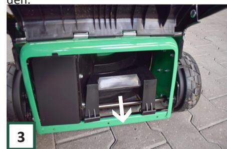
Setzen Sie nun den Mulchstopfen in das Loch für die hintere Entladung. Legen Sie den Korb nicht zurück, da die hintere Klappe den Mulchstopfen an Ort und Stelle hält.
