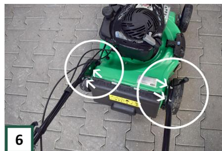
Befestigen Sie den Lenker mit 4 Schlossschrauben und Muttern an der Außenseite der Halter an der Maschine. Verwenden Sie den Schraubenschlüssel 13. Schrauben innen, Muttern außen.
