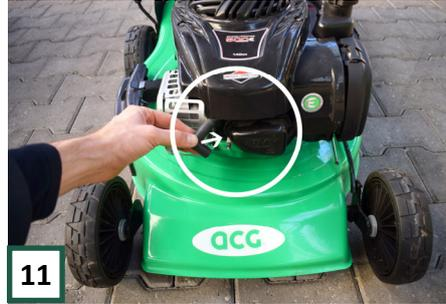
Setzen Sie dann das Zündkerzenkabel wieder auf die Zündkerze. Die Montage der Maschine ist nun abgeschlossen.
