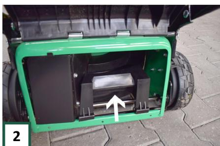
Setzen Sie dann den Mulchstopfen ein und senken Sie die hintere Klappe ab. Dadurch bleibt der Stopfen an Ort und Stelle. Sie können jetzt mähen.
