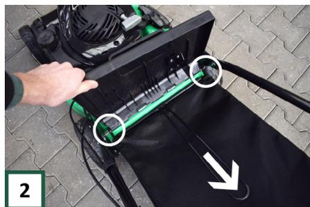
Und den Korb entfernen lassen. Senken Sie die hintere Klappe und beginnen Sie zu mähen.
