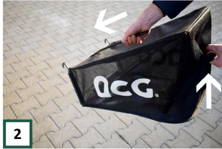
Der Fangkorb hat also eine Halterung und einen praktischen Griff auf der Rückseite-Sie können den Beutel leicht kippen, um das gesammelte Gras zu entfernen. Dann ersetzen Sie der Fangkorb.
