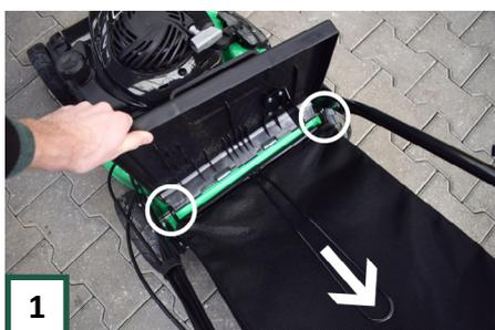
Wenn Sie die Mulchoption verwenden möchten, stellen Sie sicher, dass der Fangkorb entfernt ist.
