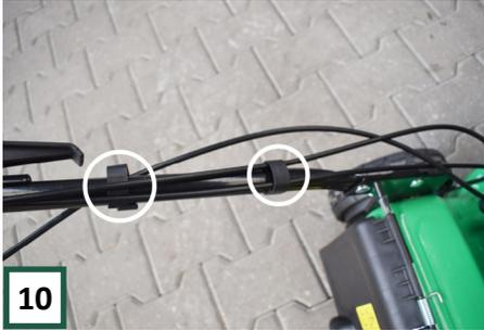
Verwenden Sie die Klemmen um den Lenker, um die Kabel zu führen.
