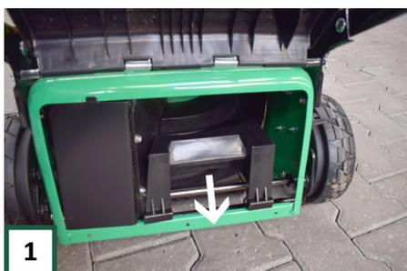
Wenn Sie den Fangkorb oder die hintere Entladung verwenden möchten, stellen Sie sicher, dass der Mulchstopfen entfernt ist.
