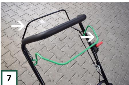
Setzen Sie dann den grünen Griff für den Motorbremse und den schwarzen Griff für die selbstfahrende Funktion wie oben gezeigt ein.
