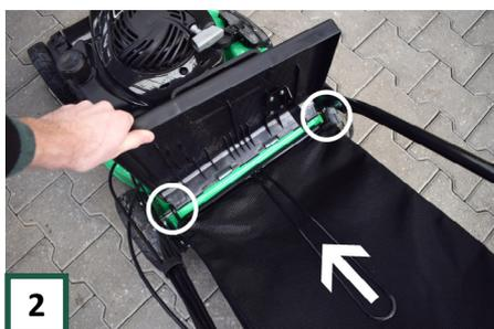
Platzieren Sie dann den Korb oder die hintere Entladung, indem Sie die hintere Klappe hochziehen und das Teil am Rahmen einhaken.
