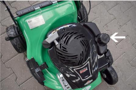
Öffnen Sie den Tankdeckel und füllen Sie den Tank mit Benzin. Schließen Sie dann die Kappe wieder.
