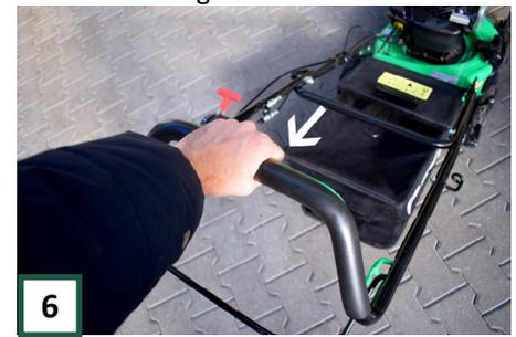
**6** Sie können die Maschine benutzen, indem Sie den vorderen Hebel gedrückt halten und die Maschine drücken. Um den Motor zu stoppen, lassen Sie den grünen Hebel los.
