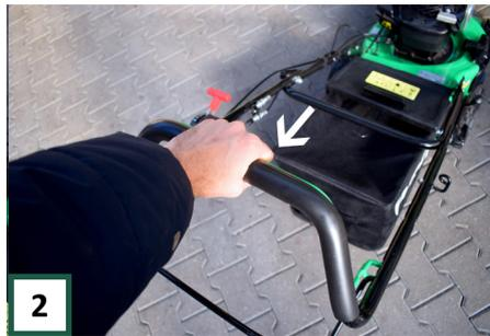
**2** Stellen Sie sich hinter die Maschine und drücken Sie mit der linken Hand auf den vorderen Steuerhebel. (Der Betrieb des Motors)
