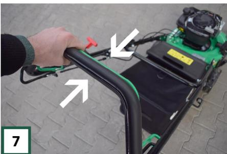
**7** Es ist auch möglich, die Selbstfahrfunktion durch betätigen des hinteren Hebels zu aktivieren.
