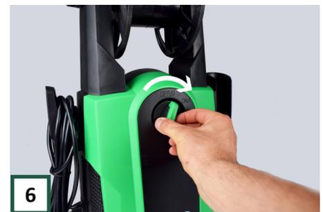
6 Drehen Sie dann den Knopf an der Maschine in die Position „ON / 1“. Es ist jetzt betriebsbereit. (Sie können die Maschine hier auch wieder ausschalten. **Schalten Sie zuerst aus und schließen Sie dann den Wasserhahn!**)
