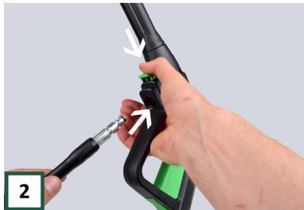
2 Drehen Sie den Hochdruckschlauch von der Rolle und verbinden Sie ihn mit der Sprühlanze über die Bajonettkupplung. Drücken Sie die Taste platziert den Stecker. Überprüfen Sie, ob es steckt.
