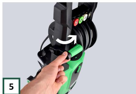
**5** Drehen Sie den Rollengriff nach innen, damit sich die Rolle nicht von selbst abwickelt. **(Stellen Sie sicher, dass der Schlauch immer etwas locker ist, um ein Knicken zu vermeiden!)**
