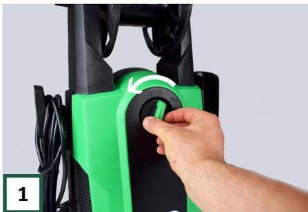
**1** Drehen Sie den Knopf vorne auf „OFF / 0“ und schließen Sie den Wasserhahn. Entfernen Sie dann den Wasserschlauch unten.
