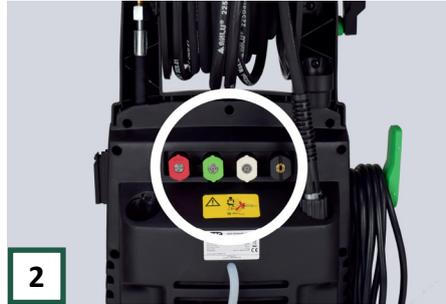
**2** Setzen Sie alle Düsen wieder in die Maschine ein.
