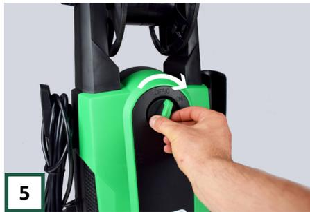
5 Drehen Sie dann den Knopf an der Maschine in die Position „ON / 1“. Es ist jetzt betriebsbereit. (Sie können die Maschine hier auch wieder ausschalten. **Schalten Sie zuerst aus und schließen Sie dann den Wasserhahn!**)
