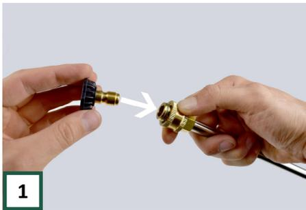
1 Stellen Sie die Maschine auf ebenen Boden und plaziere ein Düse, indem Sie die Schnellkupplung zurückziehen. Überprüfen Sie, ob die Teile festsitzen. (TIPP: Siehe S. 11 zur Auswahl der richtigen Düse.)
