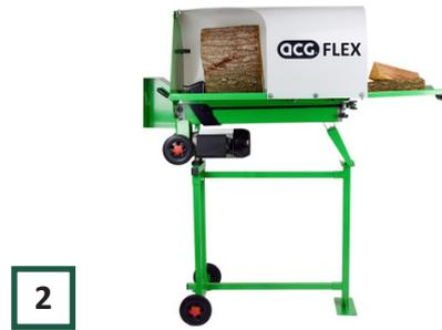
2 Stellen Sie den Spalter auf Arbeitshöhe von mindestens 730 mm und weniger als 1530 mm über dem Boden. Verwenden Sie dafür zum Beispiel das entsprechenden Untergestell von ACG.
