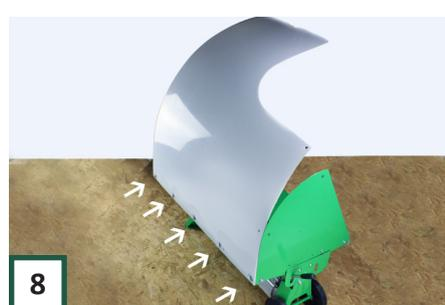
**8** Montieren Sie das lange Teil der Schutzhabe (D) mit 5 Schrauben, 5 großen Scheiben außen und 5 kleinen Scheiben und Muttern innen an Teil A.
