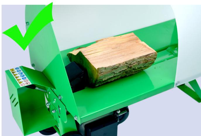
Stellen Sie gerade geschnittenes Holz bereit und legen Sie das Holz der Länge nach auf die Maschine. Stellen Sie sicher, dass das Holz am Spaltmesser anliegt, bevor Sie anfangen.
