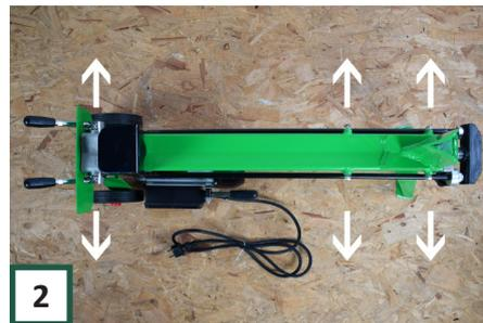
**2** Entfernen Sie die 6 Schrauben (M8) einschließlich Unterlegscheiben (wie oben gezeigt) von der Maschine.
