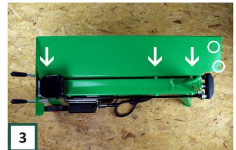
**3** Montieren Sie Teil A mit den Schrauben aus Schritt 2. Positionieren Sie A mit den in den Kreisen angegebenen Löchern.
