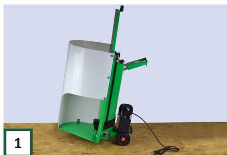
**1** Plazieren Sie den Druckblock in der Ausgangsposition und Entfernen den Stecker aus der Steckdose. Stelle die Maschine dann Vertikal auf. (Ohne Teil F siehe , S. 6) Zur Stabilität auf ein Stück Holz legen.
