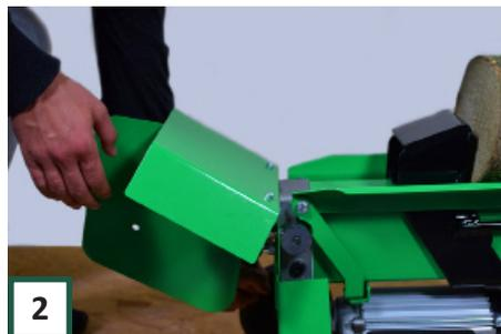
**2** Lassen Sie einen der Hebel los. Der Druckblock wird an die Stelle stehen bleiben.
