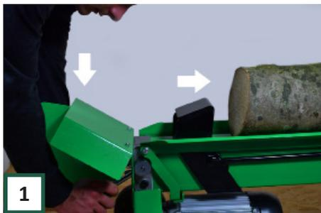
**1** Bewegen Sie den Druckblock nach vorne bis zu dem Punkt, an dem Sie es festsetzen möchten. Durch vollständiges Herunterdrücken der Bedienhebel.
