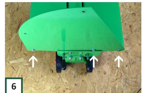
**6** Verwenden Sie zur Montage 3x M8-Schrauben, 3 kleine Unterlegscheiben außen und 3 kleine Unterlegscheiben und Muttern innen.
