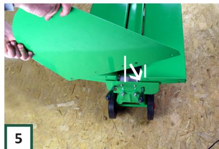
**5** Montieren Sie Teil C zwischen den Teilen A und B und der Maschine mit der abgeschrägten Seite nach rechts (wenn Sie hinter der Maschine stehen).
