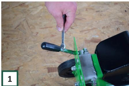
**1** Entfernen Sie alle Teile aus der Verpackung. **TIPP:** Platziere den Body für effiziente Arbeit auf einer Erhebung, Schrauben Sie die hebel fest mit Schlüssel 10 mm.
