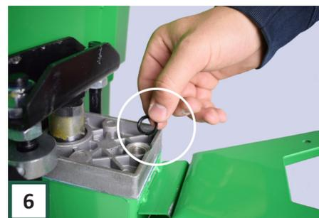
**6** Überprüfen Sie vor dem Austausch des Ölmesstabs den Dichtring und ersetzen Sie sie, falls sie beschädigt ist. (Nicht zu fest anziehen, da dies den Ring beschädigen kann.) Sie sind jetzt mit dem Ölstand fertig.
