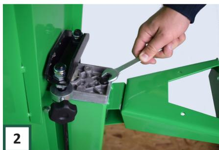
**2** Schrauben Sie die Ölmesstab mit einem 16-Gabelschlüssel aus. (Lassen Sie den Dichtring nicht fallen oder verlieren Sie sie nicht, Abb. 6, wenn Sie den Ölmesstab entfernen.)
