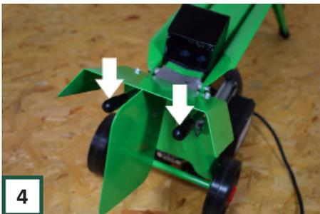
4 Drücken Sie beide Hebel mit beide Händen ganz nach unten. Dadurch bewegt sich das Druckstück vorwärts.
