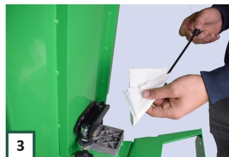
**3** Reinigen Sie den Ölmesstab und den Dichtring mit einem Tuch oder einem Stück Papier.
