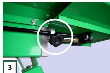
**3** Schieben Sie die Feststerring mit Ihrer freien Hand gegen die Vorderseite der Maschine. Drehen Sie die Schraube fest. Die Spaltlänge ist damit eingestellt.
