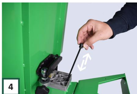
**4** Setzen Sie dann den Ölmesstab mit Ring wieder in den Ölbehälter und schließen Sie ihn vollständig. (Nicht zu eng, dies kann den Ring beschädigen). Öffnen Sie dann den Ölmesstab und nehmen Sie sie vollständig aus dem Ölbehälter.
