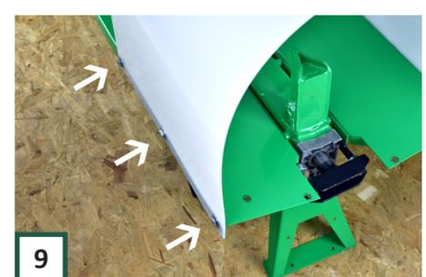
**9** Falten Sie nun die Schutzhaube und befestigen Sie es auf die gleiche Weise mit 3 Schrauben, Unterlegscheiben und Muttern an der anderen Bodenplatte, Teil B.
