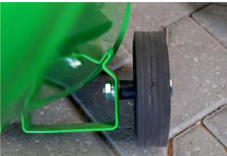
Montieren Sie die Räder wie oben gezeigt auf beiden Seiten der Maschine. Schieben Sie den schrauben von außen durch das Rad, setzen Sie eine Unterlegscheibe ein und führen Sie das Gewindeende des Bolzens durch den Radstand der Maschine. Setzen Sie dann eine Unterlegscheibe, eine Federscheibe und eine Mutter auf die Innenseite des Radstands über das Gewindeende und ziehen Sie die Baugruppe fest.
