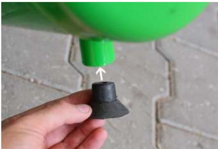
Bei der 24/10-BASIC-Version können Sie den GummifuÙ (32) wie oben gezeigt auf die Platte in das Rohr unten an der Maschine drücken. Beim 50/10 BASIC sehen Sie die Montageabfolge der beiden GummifuÙe gegenüber.
