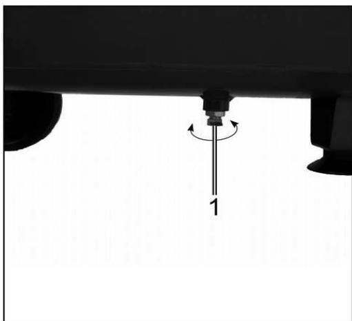
Es wird empfohlen, den Kessel nach jeweils 20 Stunden Gebrauch zu entlüften und eventuell vorhandene Feuchtigkeit abzuleiten. An der Unterseite des Tanks befindet sich ein Stopfen, den Sie öffnen können. **Stellen Sie sicher, dass Sie zuerst den Druck des Tanks durch die Schlauch-/Luftpistole ablassen und dann den Stopfen unten öffnen.**
