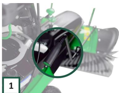
**1** Ziehen Sie die Bürstenwinkel-Einstellhalterung zu sich heran oder schieben Sie sie von sich weg, um die Bürstenposition einzustellen.
