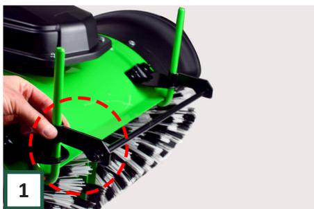
Schieben Sie die Kupplung über die beiden Stifte des Kehrbürstenschutzes.
