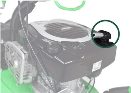
Schrauben Sie den Deckel des Kraftstofftanks ab und füllen Sie den Tank mit Benzin. Schließen Sie dann die Kappe wieder.
