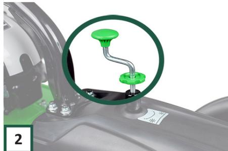
Stellen Sie sicher, dass das Schneeräumschild auf Höhe eingestellt wird, indem Sie das Laufrad nach oben oder unten drehen.
