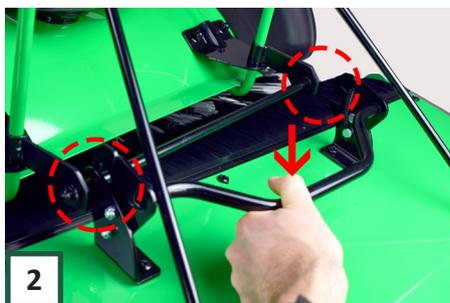
Drücken Sie auf die Halterung am Trichter, um ihn mit der Maschine zu verbinden oder von dieser zu entfernen.
