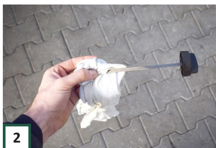
Trocknen Sie den Messstab anschließend mit einem Tuch oder einem Stück Papier ab.
