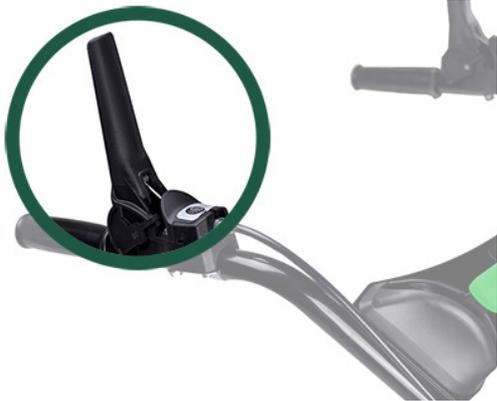
Sie können den Radantrieb einschalten, indem Sie den rechten Steuerhebel drücken. (Rechts aus Arbeitsposition hinter der Maschine gesehen) Dieser Hebel ist auch mit einem Radaufkleber gekennzeichnet.
