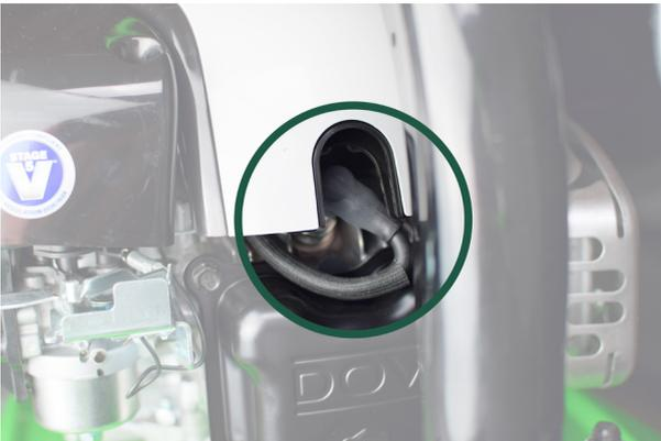
Vergewissern Sie sich, dass das Zündkerzenkabel an der Zündkerze angeschlossen ist, bevor Sie die Maschine starten.
