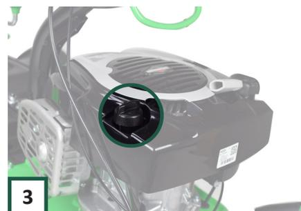
Setzen Sie dann den Messstab wieder in den Ölbehälter ein. Schrauben Sie dann die Kappe wieder ab und entfernen Sie sie vollständig aus dem Reservoir.
