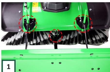
Platzieren Sie die beiden Halterungen über den Stiften der Kehrmachine und stellen Sie sicher, dass der Haken zwischen den Bürsten über den Buchsen passt.
