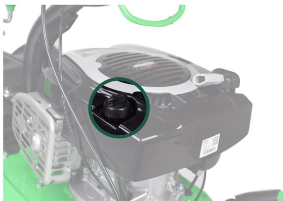
Entfernen Sie den Messstab und stellen Sie sicher, dass der Dichtring des Messstabs an Ort und Stelle bleibt. Dann 0,6 Liter Öl hinzufügen (genau auf der obersten Ebene), nicht weniger, aber auch nicht mehr hinzufügen! SAE 30 oder gleichwertiges Motoröl verwenden.
