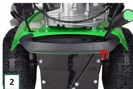
Verwenden Sie Position 3 für leicht verschmutzte Oberflächen. Sie werden früher fertig sein.
