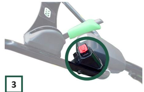
**3** Wenn Sie eine Maschine mit Elektrostart besitzen, können Sie die Maschine auch durch Drücken des roten Startknopfes starten.
