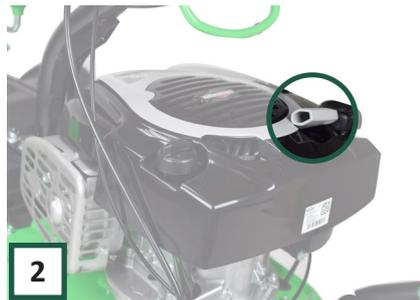
**2** Verwenden Sie die Zugschnur am Motor, um die Maschine zu starten. Ziehen Sie das Kabel in einer sanften Bewegung zu sich heran.
