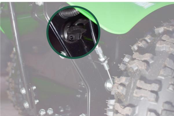
Wenn Sie eine Maschine mit Elektrostart haben, können Sie die Batterie aufladen. Den Anschluss finden Sie unten rechts am Rad (von der Arbeitsposition aus gesehen rechts hinter der Maschine) Sie können die Abdeckung anheben und das Kabel platzieren. Stecken Sie den Adapter in die Steckdose und lassen Sie ihn aufladen.
