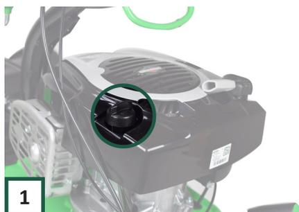
Stellen Sie sicher, dass die Kehrmaschine waagrecht zum Stillstand gekommen ist. Öffnen Sie dann die Kappe mit dem Messstab. (Gießen Sie 0,6 Liter Öl in den Behälter, bevor ersten Mal verwenden)
