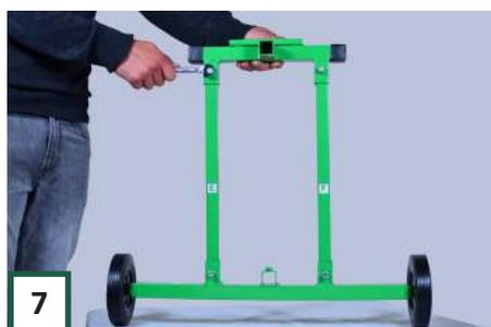
**7** Montieren Sie nun den Teil "D" an den anderen Enden der Teile "E & F". Ziehen Sie es mit zwei 8mm Schrauben fest.
