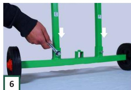
**6** Schieben Sie dann Teile "E & F" in Teil "G". Verwenden Sie zwei 8-mm-Schrauben, um sie festzuhalten
