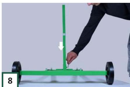
**8** Platzieren Sie dann es vollständig horizontal, Und schiebt Teil "B" in Teil "D" und ziehen Sie es mit einer 8 mm Schraube fest.
